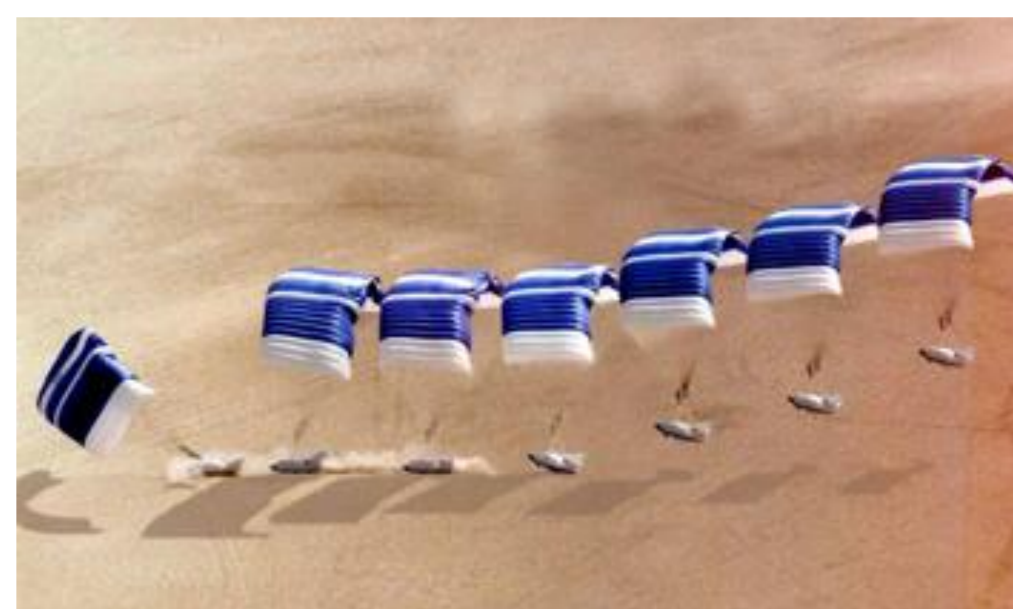
图1 冲压翼伞的滑翔过程
