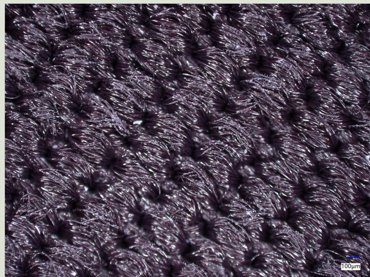
图1 跑步运动服表面结构
